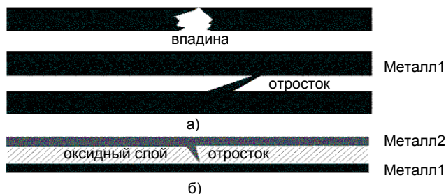
Рис. 1. Нарушения, образованные вследствие электромиграции в металлических проводниках: а – в одном слое; б – между двумя слоями
