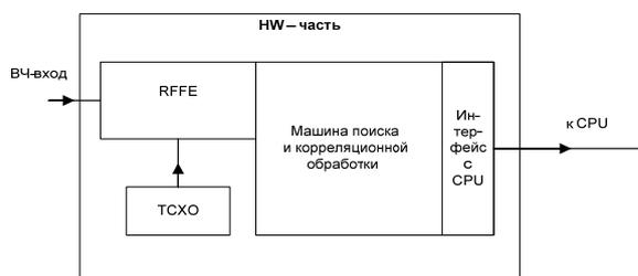
Рис. 7. Смешанный чип для приемника, в котором частично навигационные функции выполняются CPU
