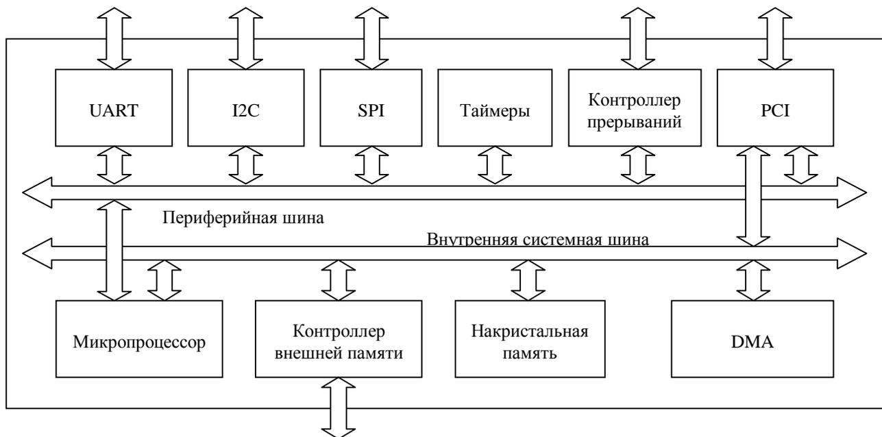
Рис. 1. Пример системы на кристалле
