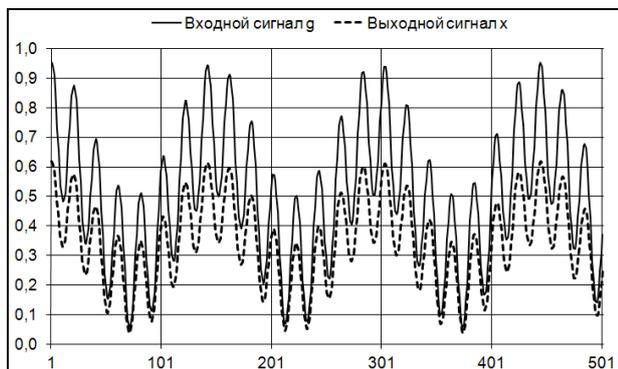
Рис. 5. Сигналы в УМ с нелинеаризованной амплитудной характеристикой ( $u = g$ )
