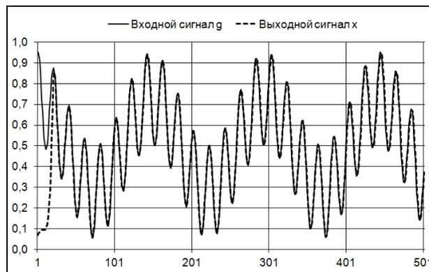
Рис. 6. Сигналы в адаптивной системе с линеаризованной амплитудной характеристикой ( $u = w_0 \cdot g$ )
