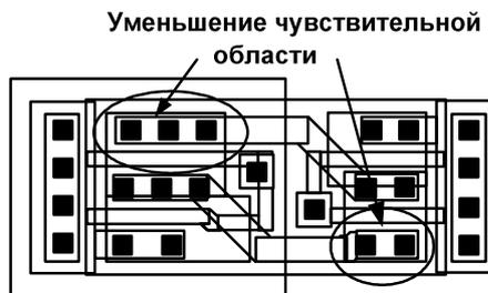
Рис. 5. Эскиз топологии сбоеустойчивого инвертора, разработанного по нормам проектирования КМОП 0,18 мкм
