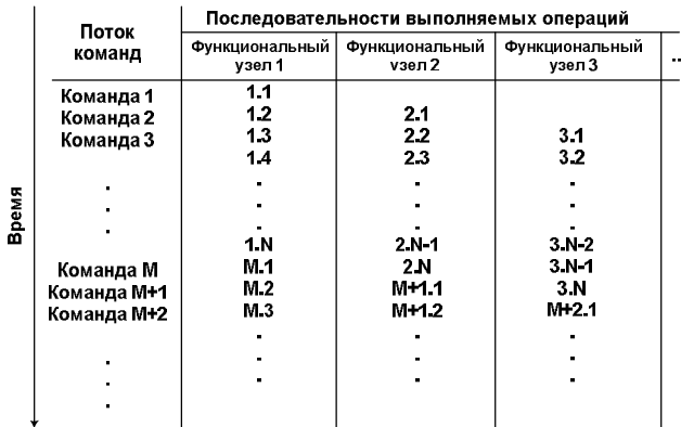
Рис. 4. Векторно-конвейерная организация вычислений (динамический VLIW)
