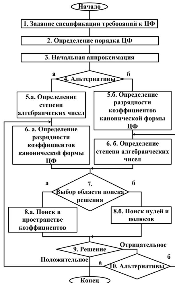
Рис. 2. Функциональный уровень проектирования
