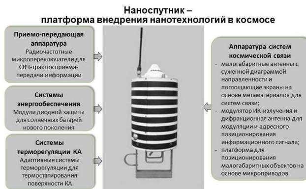
**Рис. 1. Применение МСТ и НСТ в аппаратуре РКТ**
