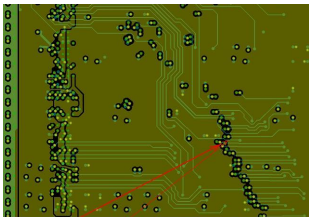
Прохождение трасс высокочастотных сигналов над разрезом в опорном слое.
