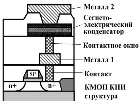
Рис. 2. Ячейка памяти, интегрированная в технологию объемного кремния с тремя уровнями металла
