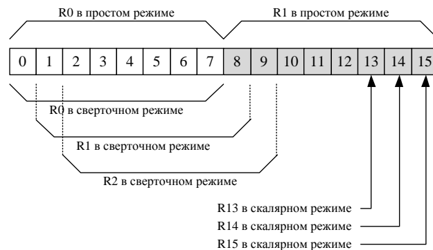
Рис. 4. Соответствие адресов в памяти регистрам в простом, скалярном и сверточном режимах адресации
