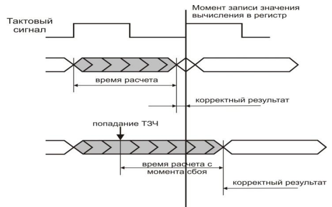
Рис. 3. Возникновение сбоя в комбинационных элементах при функционировании на максимальной частоте
