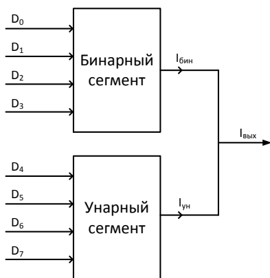
Рис. 2. Структура восьмиразрядного сегментного ЦАП
