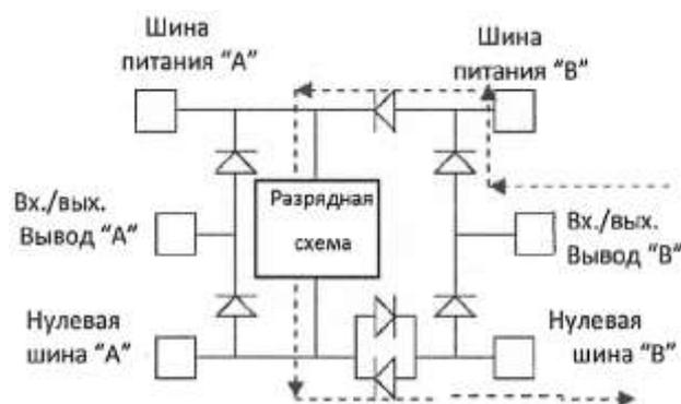
Рис. 2. Защита входных и выходных выводов с использованием одного блока разрядной схемы
