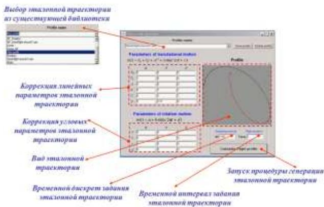
Рис. 7. Панель для задания параметров эталонных траекторий
