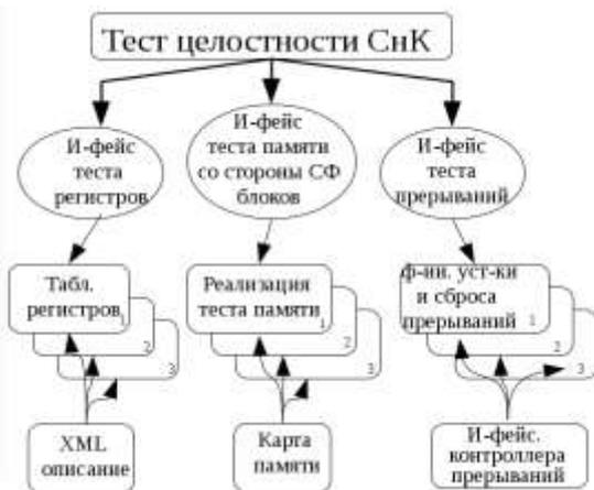
Рис. 3. Структура теста целостности, создаваемого в полуавтоматическом режиме
