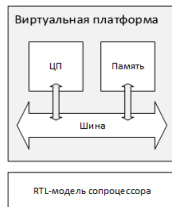
Рис. 4. Структура тестируемого фрагмента СнК
