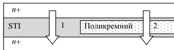
Рис. 3. Схематическое изображение путей протекания тока утечки в области STI, свободной от поликремния (1) и под поликремнием (2)
