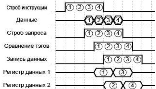
Рис. 4. Временная диаграмма, отображающая обработку запросов на сохранение данных при наличии БВД в кэш-памяти второго уровня (помехоустойчивое кодирование отключено)
