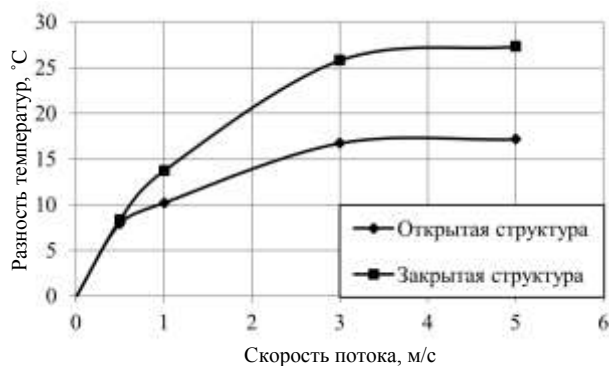
Рис. 7. Сравнение выходных характеристик первичного преобразователя с открытой и закрытой ямкой травления
