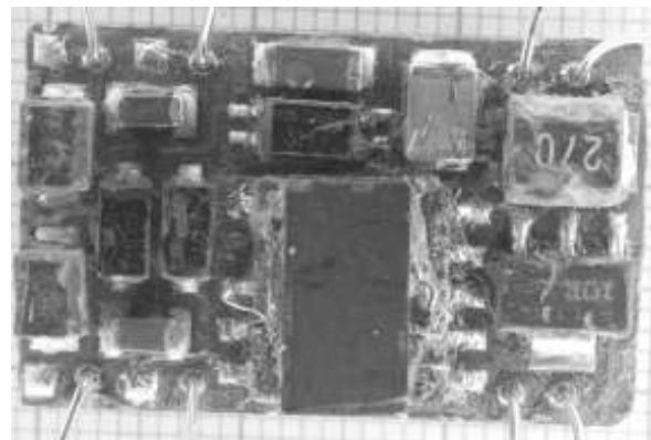
Рис. 5. Фотография вскрытого стабилизатора TEN5-2423
