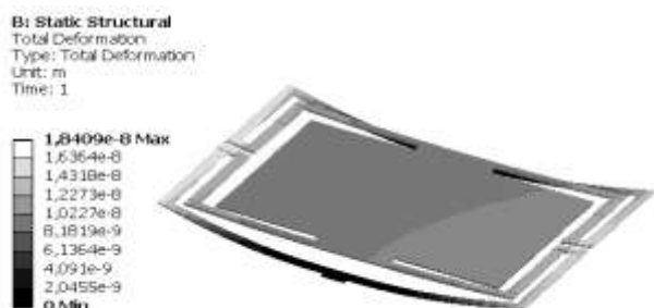
Рис. 6. Механическая деформация тестовой ячейки
