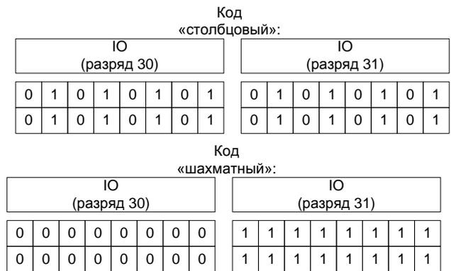
**Рис. 4. Фрагмент распределения информации в ячейках памяти при записи кодов «шахматный» и «столбцовый»**
