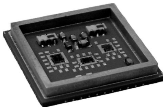
Рис. 6. ЛТСС-модуль УВЧ-тракта ИППМ (габаритные размеры 20×20×3 мм 3 )
