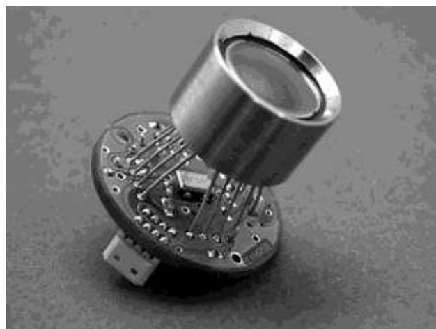
Рис. 2. Фотография модуля с матрицей НТРА32x31
