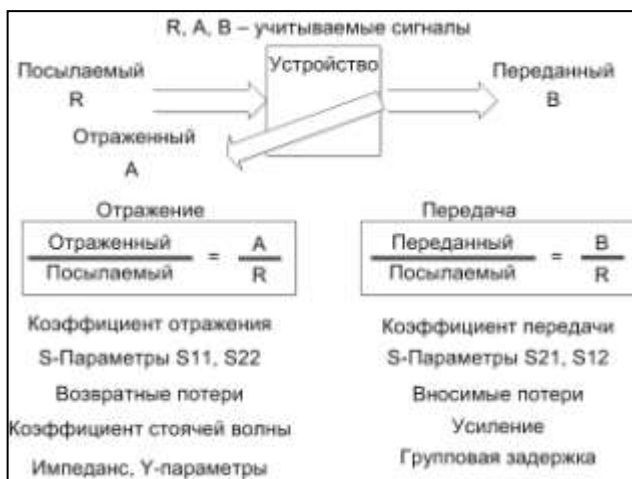
Рис. 1. Общая схема работы и основные параметры векторного анализа цепей
