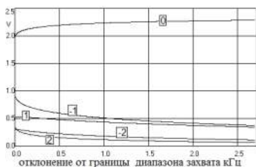
Рис. 5. Зависимости амплитуд выходных гармоник от частоты входных импульсов
