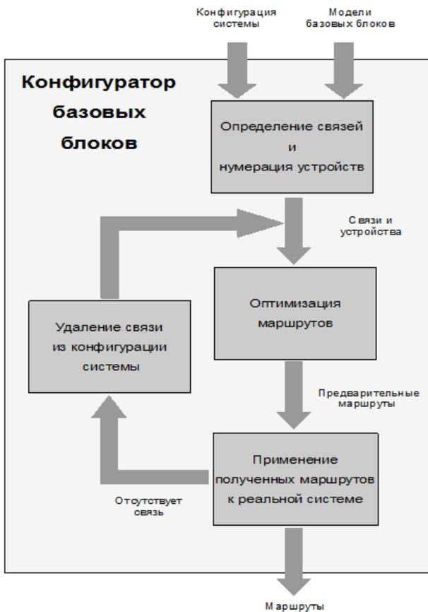
Рис. 2. Схема конфигуратора базовых блоков
