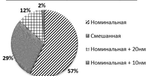
Рис. 8. Статистика использования ячеек с различной длиной канала для библиотеки 55 нм/13 трасс
