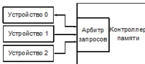
Рис. 1. Схема обращения устройств к памяти
