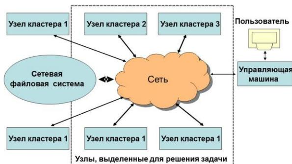
Рис. 1. Конфигурация аппаратуры при выполнении MPI-программы
