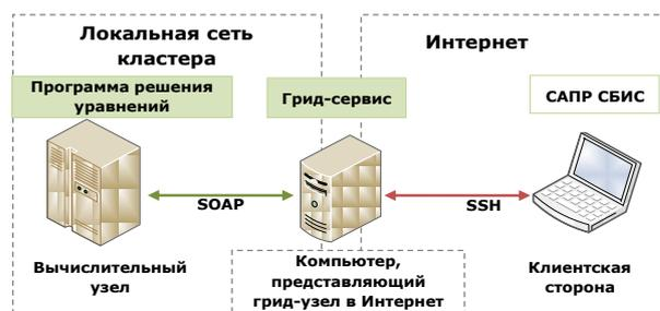
Рис. 3. Распределенная программа грид-сервиса решения логических уравнений на суперкомпьютере
