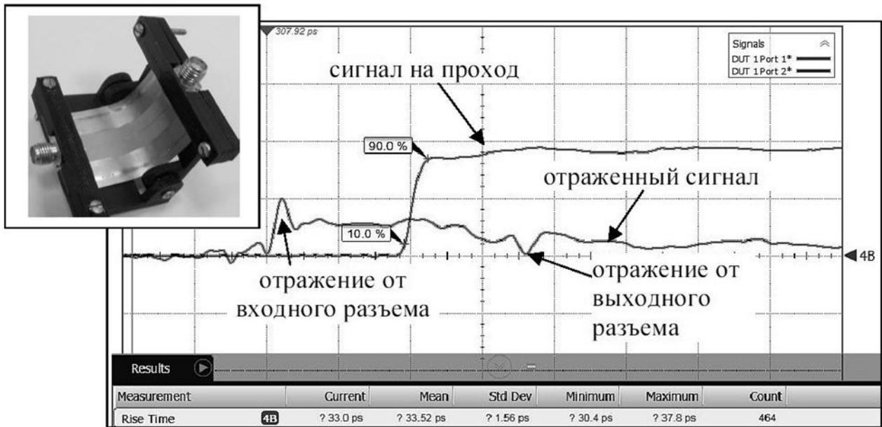
**Рис. 4.** Прохождение прямого и отраженного сигналов в СВЧ полиимидной копланарной конструкции (длина линии 3,6 см, ширина полоска 100 мкм)
