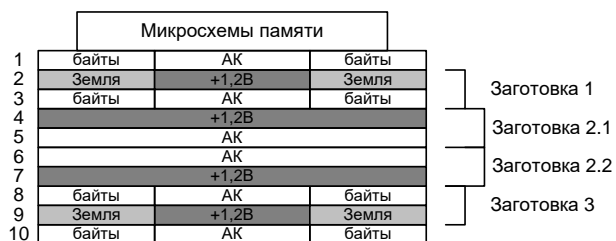
Рис. 3. Структура опорных полигонов питания в модуле памяти
