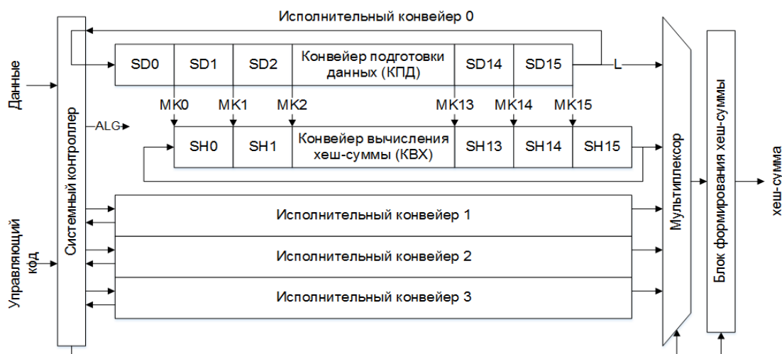
Рис. 1. Мультиконвейерная архитектура криптоблока
