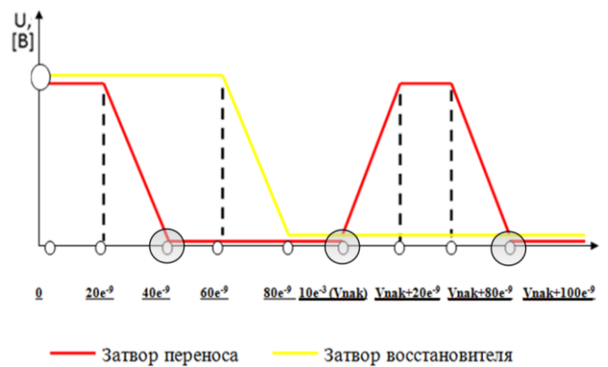
Рис. 12. Потенциальная диаграмма управляющих импульсов
