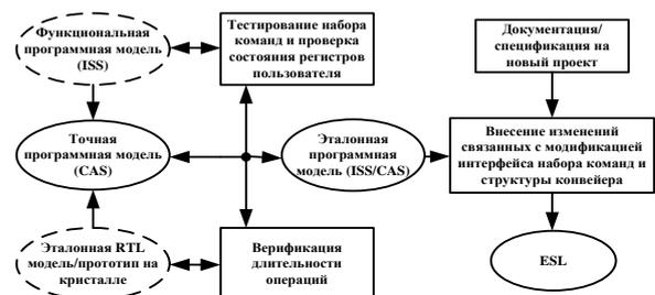
Рис. 5. Принцип повторного использования модели
