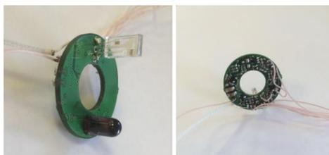
Рис. 8. Макет фотоприёмного устройства
