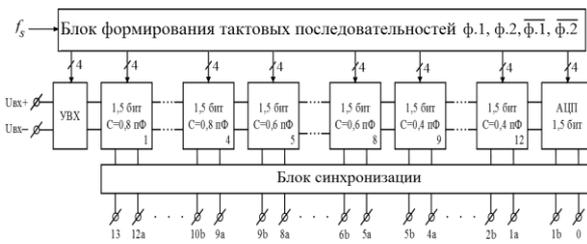
Рис. 9. Структурная схема конвейерного АЦП разрядностью 14 бит
