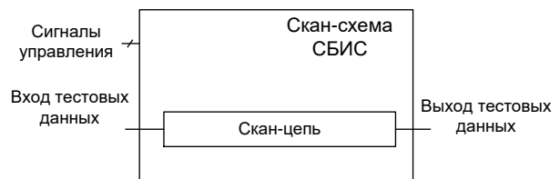
Рис. 7. Скан-схема СБИС с одной скан-цепью
