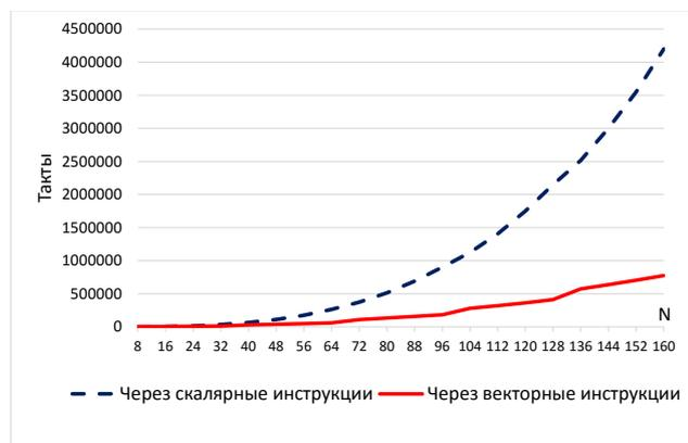
Рис. 8. Время работы произведения матриц 32-разрядных чисел с фиксированной точкой, реализованного через скалярные и через векторные инструкции
