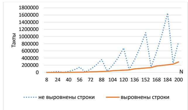
Рис. 6. Влияние выравнивания строк на время обработки для матриц  $N \times N$  16-разрядных чисел
