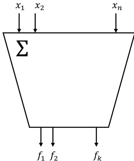
$\Sigma$  – СФЭ, реализующая систему функций алгебры логики  $\{f_1, \dots, f_k\}$  от переменных  $x_1, \dots, x_n$ .
