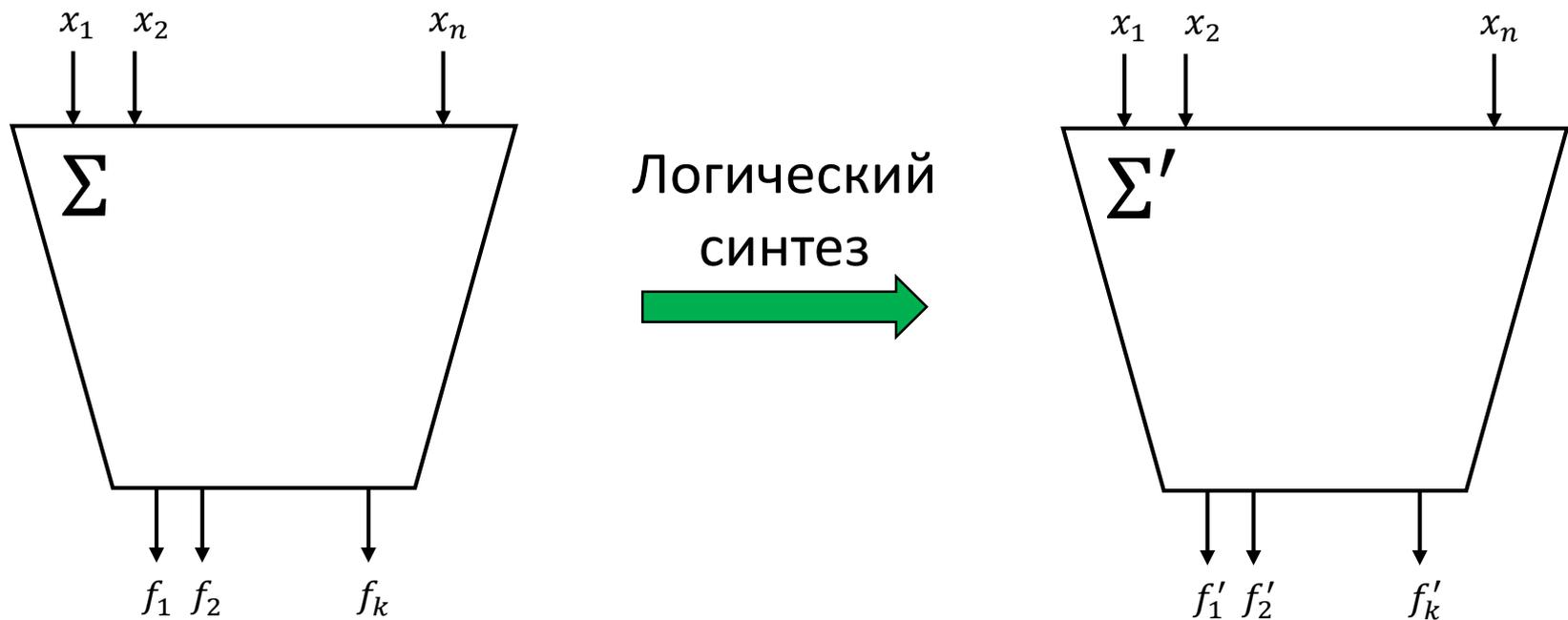
$\Sigma$  – СФЭ, реализующая систему функций алгебры логики  $\{f_1, \dots, f_k\}$  от переменных  $x_1, \dots, x_n$ .
