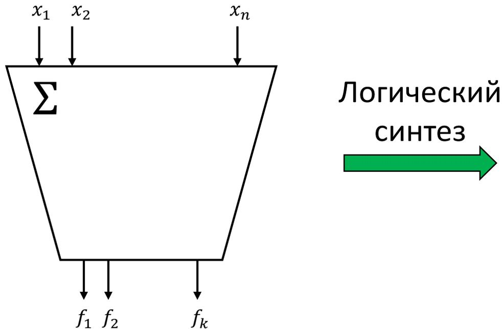
$\Sigma$  – СФЭ, реализующая систему функций алгебры логики  $\{f_1, \dots, f_k\}$  от переменных  $x_1, \dots, x_n$ .
