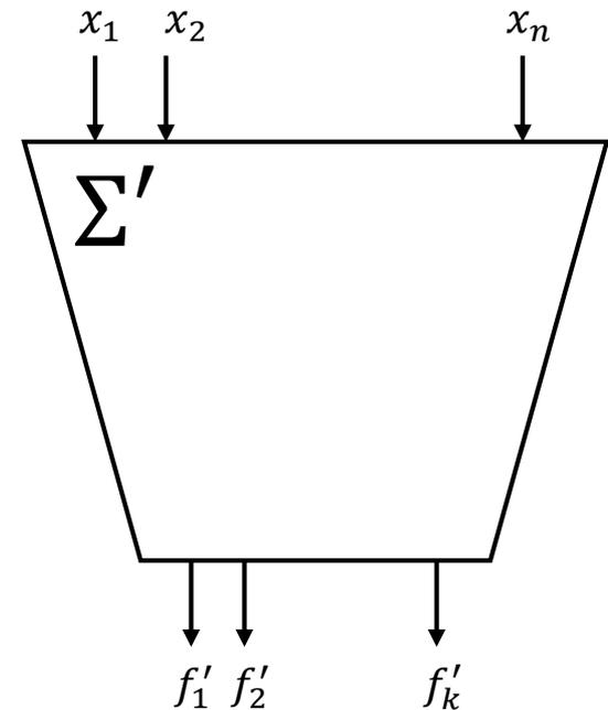
$\Sigma'$  – СФЭ, получающаяся в результате применения алгоритмов логического синтеза и реализующая систему  $\{f_1', \dots, f_k'\}$ .
