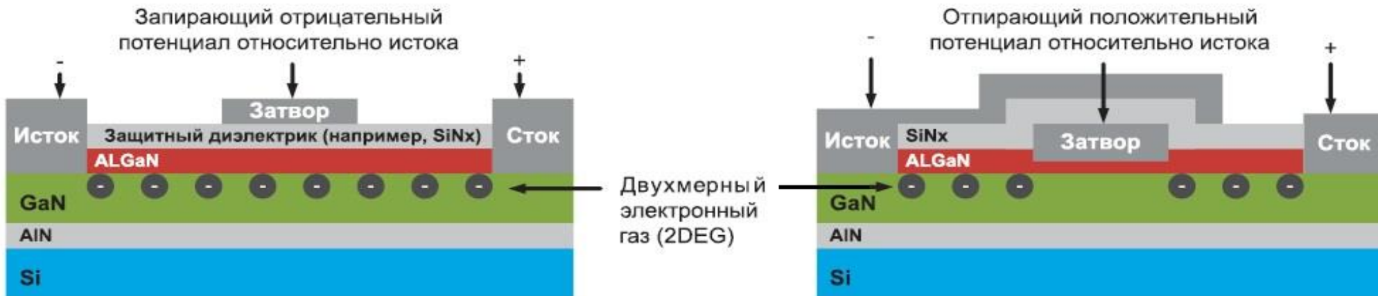
Стандартная схема GaN-транзистора
