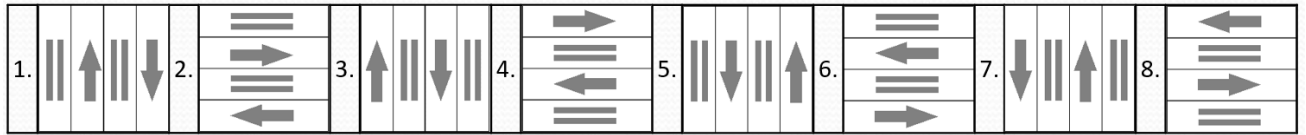
Рис. 1. Визуализация прохода схемы «sin». Указаны направления перемещений для 4-х соседних строк или столбцов по времени (знак «=>» означает отсутствие движения)
