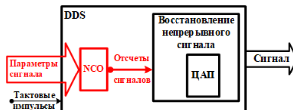
Рис. 2. Структура цифровых формирователей сигналов на основе прямого частотного синтеза
