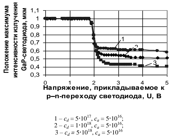
Рис.5. Зависимости положения максимума интенсивности излучения GaP-светодиодной структуры от координаты, полученные с применением MOD-1D при различных значениях c_d
