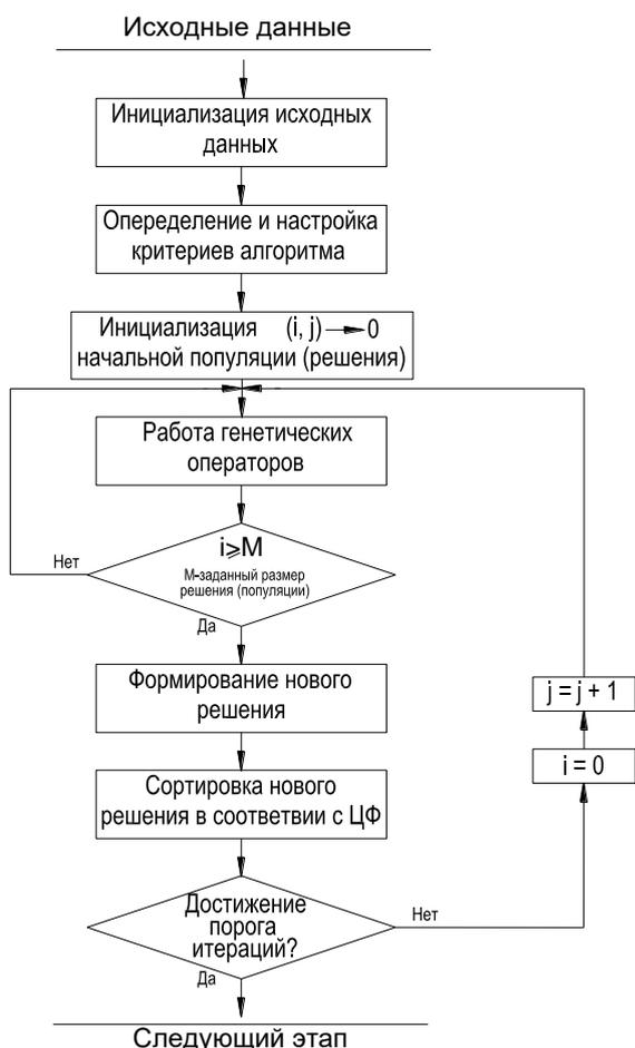
Рис. 5. Структурная схема алгоритма начального размещения
