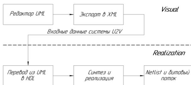
Рис. 3. Алгоритм методики синтеза проекта ПЛИС с использованием визуальных языков
