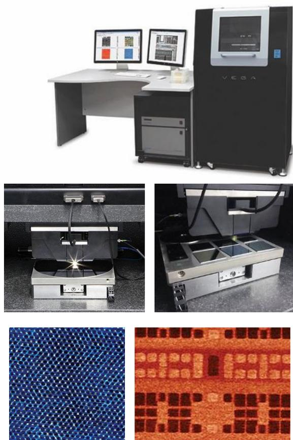
Si пластина диаметром 200 мм и набор образцов на рабочем столе микроскопа АСМ НОРР 6х6 нм; распределение поверхностного потенциала на кремниевой наноструктуре 40х40мкм.
