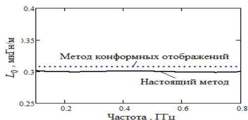
Рис. 9. Частотная зависимость погонной индуктивности КПЛ
